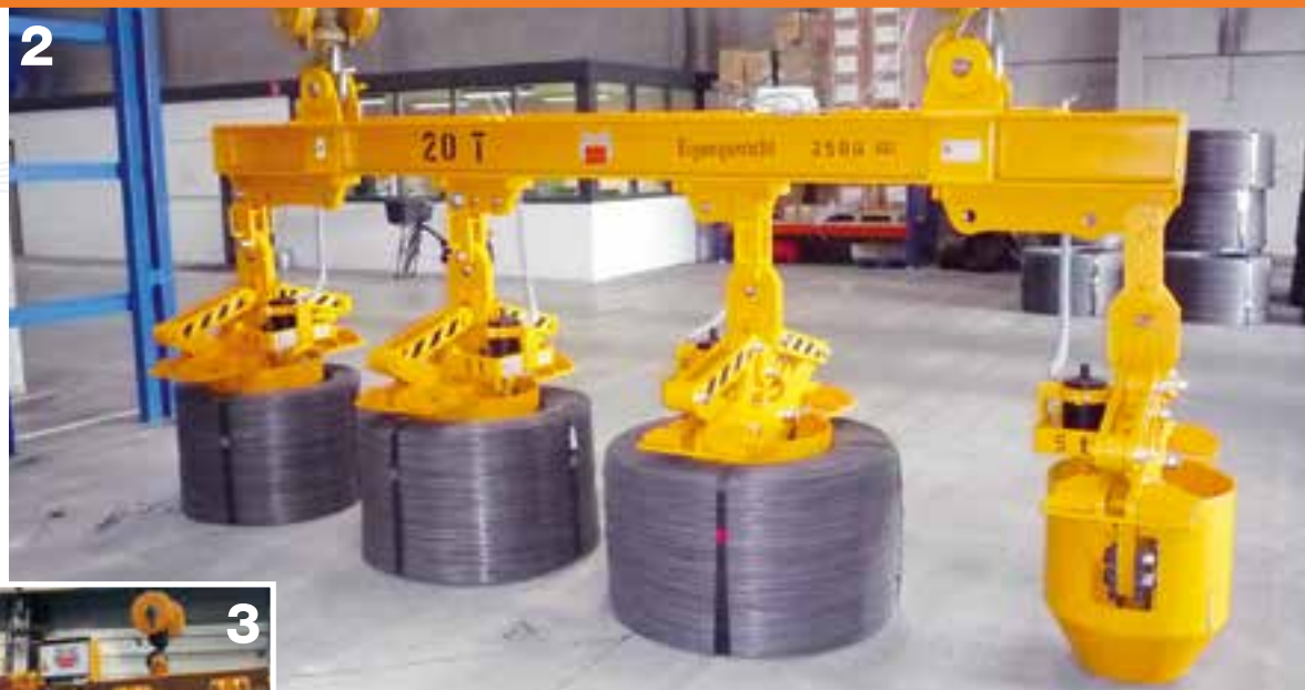
2 Drahtcoilinnenzangen in 4-facher Anordnung mit Zentrierhilfe und elektromagnetischer Entriegelung. Abstand über Steckbolzen verstellbar. Four Wire Coil Inner Tongs with Infeed Guides and Electromagnetic Release. Distance Adjustable by Plug Pins.
