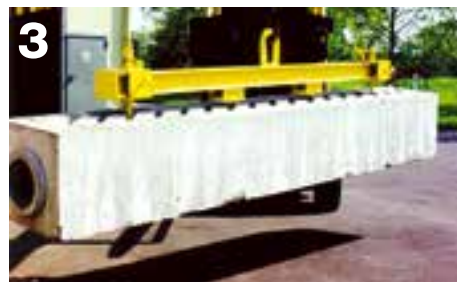
1 Adaptertraverse für Containerspreeder Adapter Lifting Beams for Container Spreader
