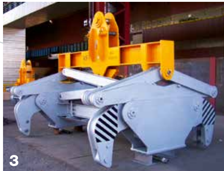
1-3 Mechanische Brammenzange mit Hitzeschutzblech - Einsatz für Heißbetrieb bei 900°C mit einer Haltezeit von 10 Minuten.
