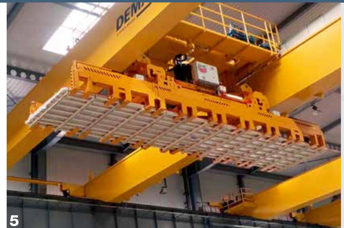
4-5 Elektromotorischer Mehrfach- Teleskop-Blechpaketgreifer Electromotive Multiple Telescopic Sheet Stack Grab
