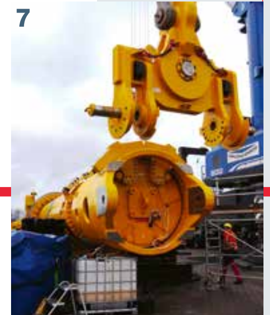
6 Auslegertraverse mit manueller Greifweitenverstellung für den Einsatz im Hafen. Beam with Manual Adjustment of Grab Range for Port Use.
