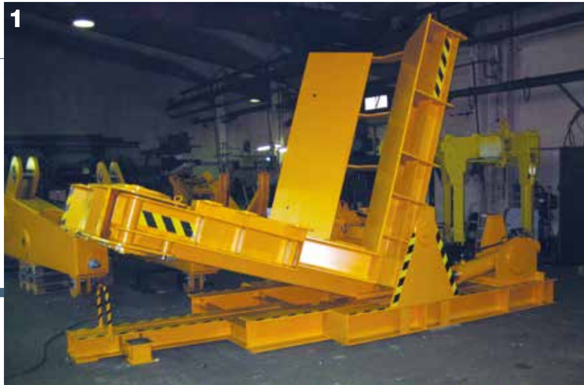
1-3 Elektrohydraulischer Kipptisch mit ausklappbaren Auslegern für besonders große zylindrische Lasten (hier: Turmsegmente für Windenergieanlagen) mit sehr unterschiedlichen Durchmessern. Electro-Hydraulic Tilting Table. With hinged side arms for extremely large loads (tower segments for wind turbines) with varying diameters.
