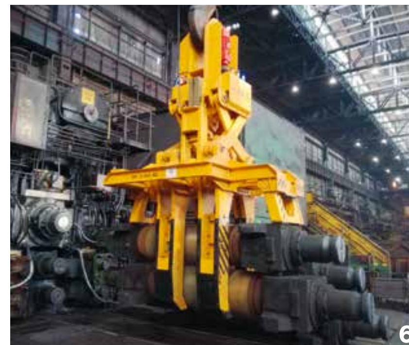
3-5 Mechanischer Walzentransportgreifer. Die Stützwalzen können sowohl mit Baustücken (durch Herunterklappen der Greiferzinken), als auch ohne Baustücke (mittels Drahtseilen) transportiert werden.
