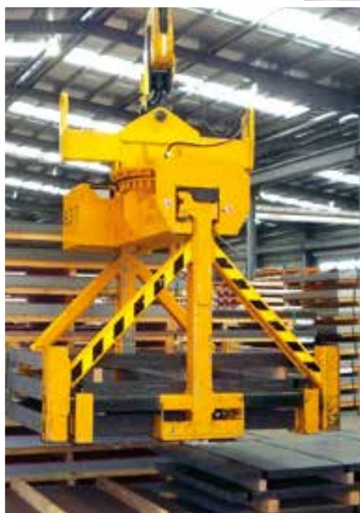
2-3 Elektromotorischer Blechpaket- greifer für Blechpakete auf Paletten Electromotive Sheet Stack Grab for sheets stacks on pallets
