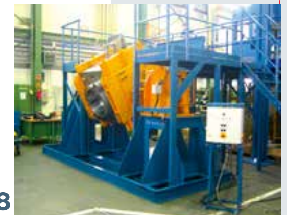
7-9 Stationäre elektrohydraulische Werkzeugwendevorrichtung Electrohydraulic turner
