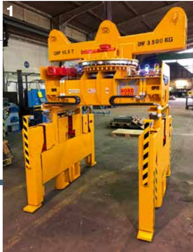
1 Elektromotorischer Mehrfach- Teleskop-Blechpaketgreifer mit Drehwerk und drehbaren Füßen für geringen Platzbedarf Electromotive Multiple Tele- scopic Sheet Stack Grab with slewing gear and rotatable feet
