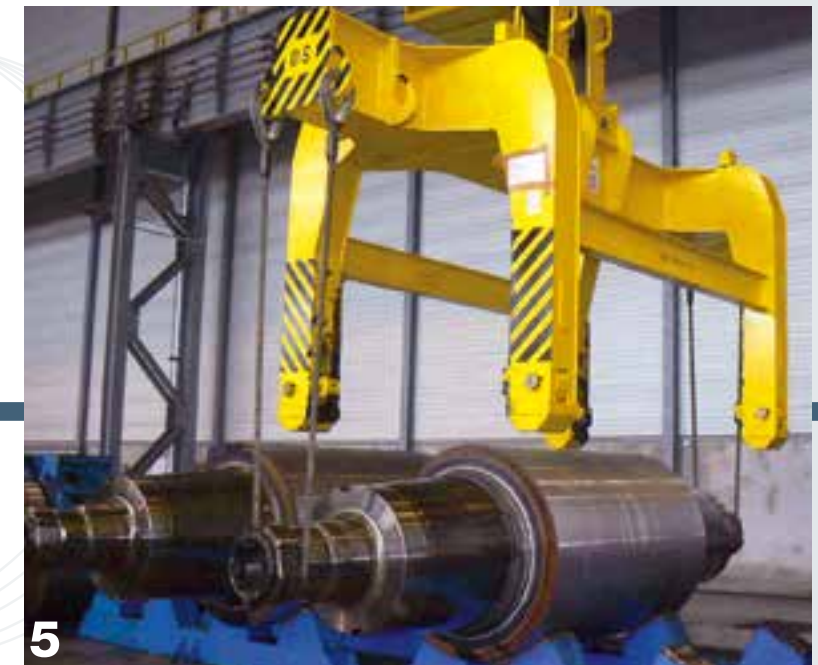
3-5 Mechanischer Walzentransportgreifer. Die Stützwalzen können sowohl mit Baustücken (durch Herunterklappen der Greiferzinken), als auch ohne Baustücke (mittels Drahtseilen) transportiert werden.
