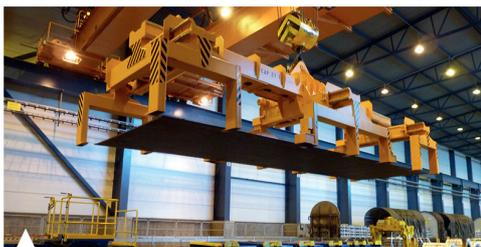
Elektromotorischer Blechpaketgreifer mit 27t Tragfähigkeit.
