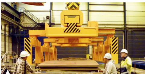
El.-mot. Blechpaketgreifer mit starren Zentralbeinen und teleskopischer Verlängerung für die äußeren Greiferbeine.
