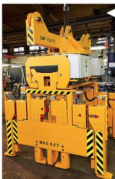
Elektromotorischer Mehrfach-Teleskop-Blechpaketgreifer mit Drehwerk und drehbaren Füßen.
