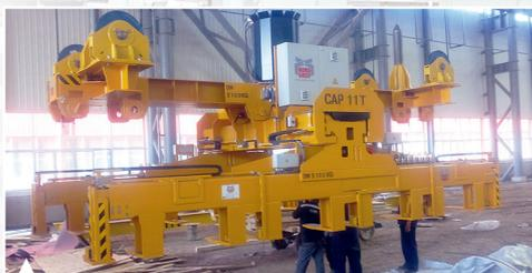
El.-mot. Blechpaketgreifer, motorisch verlängerbar, aufgehängt an Koppeltraverse für schnellen Austausch gegen einen anderen Greifer.
